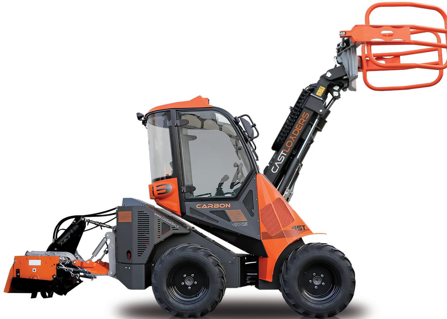
Motore Isuzu Hp 38 | Velocità 16 Km/h | Trasmissione idrostatica 4WD | Differenziale autobloccante elettrico | Raffreddamento a liquido | Parallelogramma | Portata idraulica 66 lt/min
